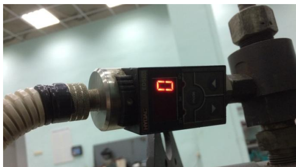
Рисунок 23. Датчик давления рабочей жидкости в гидроцилиндре
