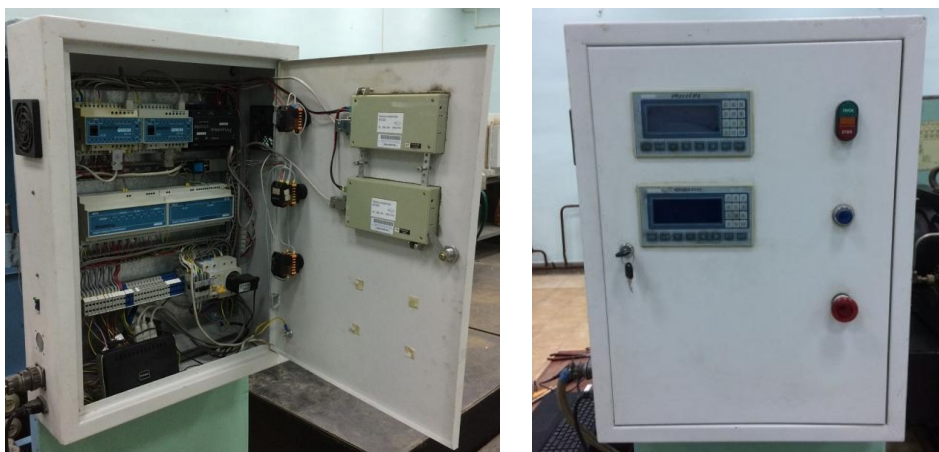
Рисунок 55. Внешний вид шкафа управления
